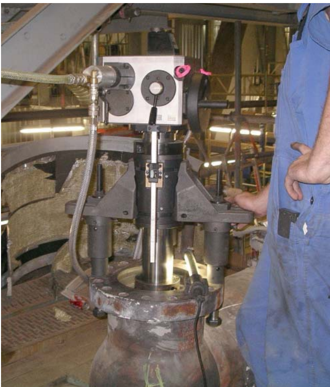
MD Anwendung vor Ort auf einem Sicherheitsventil
