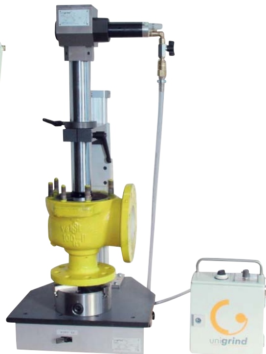
SVS 1 mit Maschinenständer beim Schleifen eines Ventils
